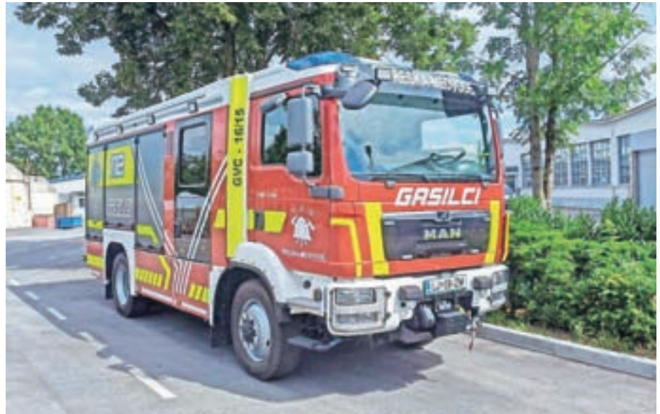
Gre za vozilo s 1500 litri vode in poudarkom na tehnični opremi.
