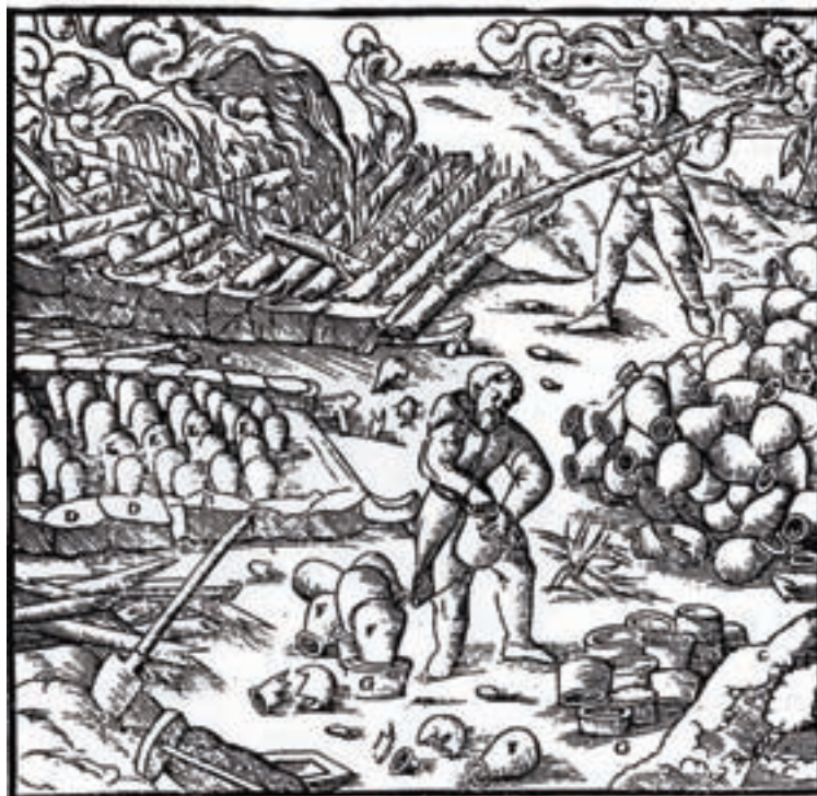
Prikaz žganja živosrebrne rude v glinenih retortah (G. Agricola: De Re Metalica, 1556)
