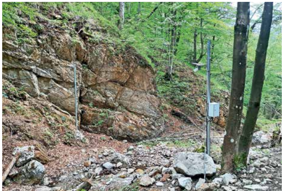
ZEMELJSKI PLAZ je velika nevarnost za Koroško Belo. Vsak njegov premik zaznajo posebne naprave, opremljene s sireno.
