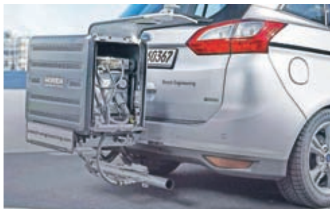
Magična meja izpustov CO 2 – 95 g/km; merjenja izpušnih plinov v praksi kažejo na velika odstopanja od laboratorijskih.
