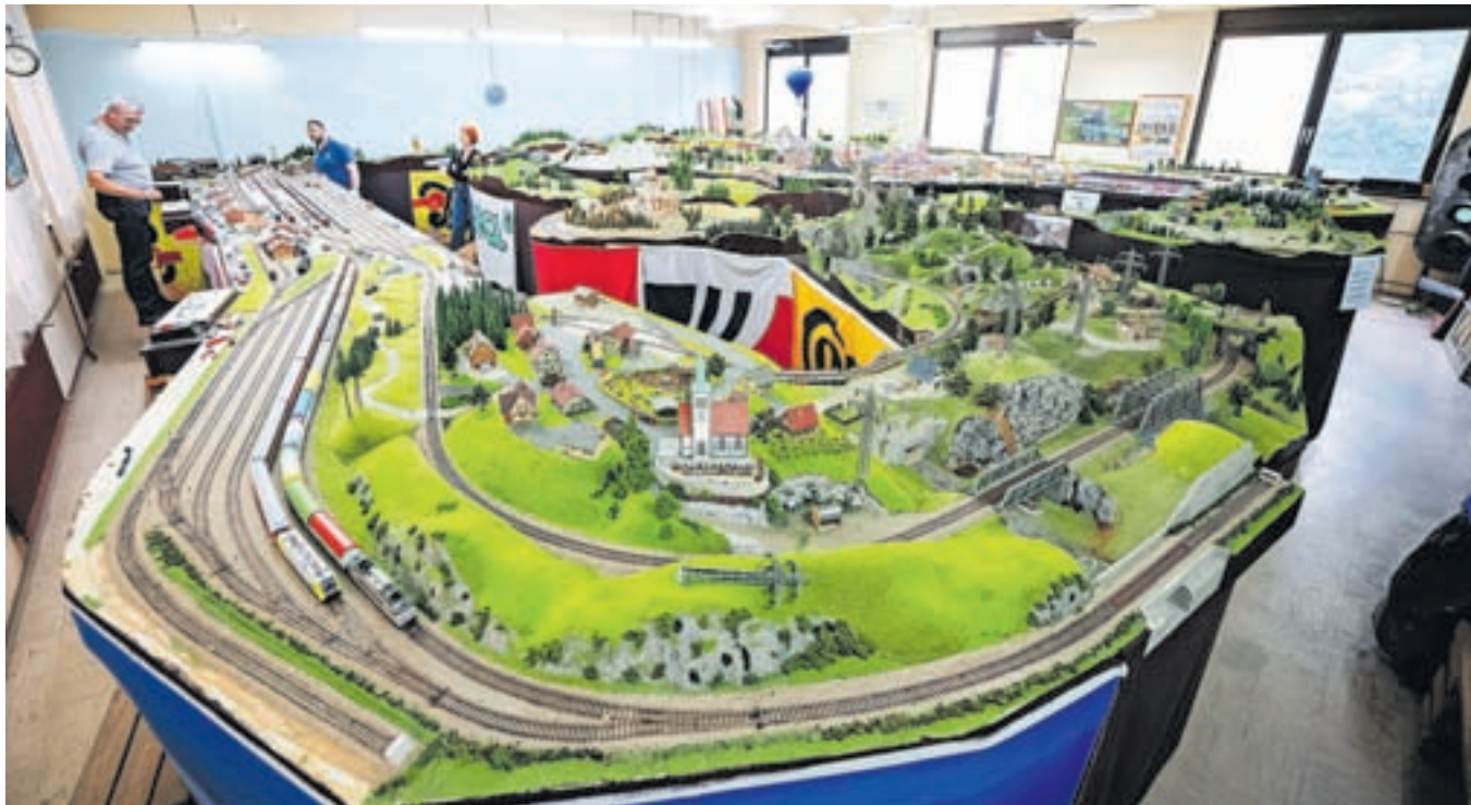
Jeseniška modulna maketa ima deset tirov v obliki pentlje, vlakce pa krmilijo analogno, prek dveh glavnih postaj.
