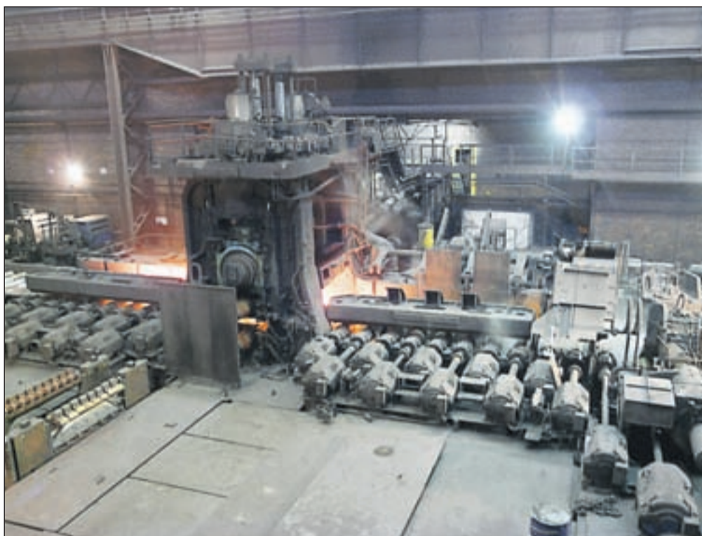
Slika obstoječega ogrodja Blooming med valjanjem predtrakov.
