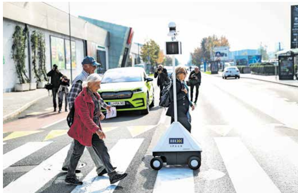
Robotski asistent za pešce IPA2X je eden prvih, ki omogoča varnejše prečkanje ceste na nesemaforiziranih prehodih. / Foto: Aljoša Rebolj
