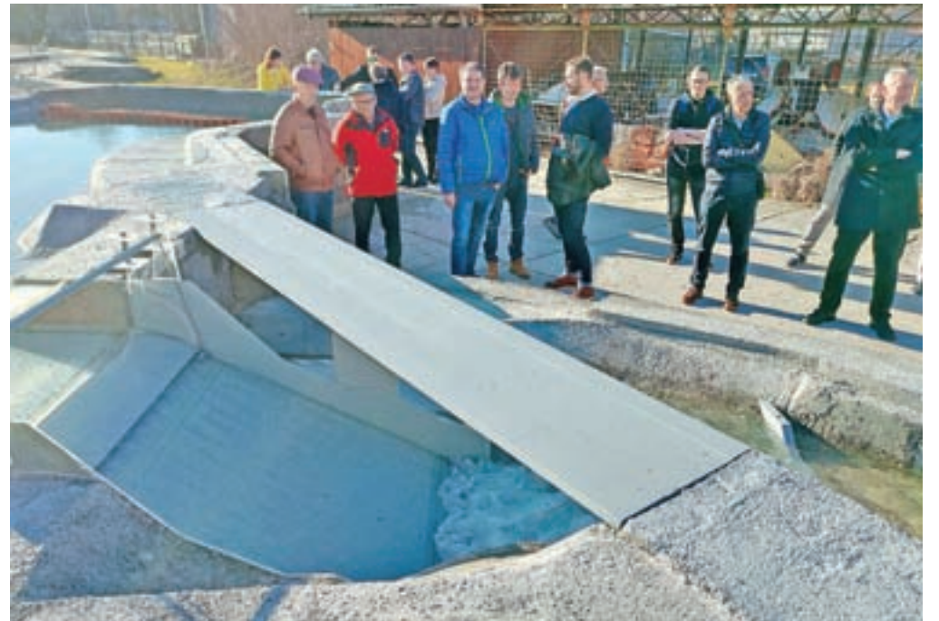
Predstavljeni model z umeščenim mostom čez pregrado je končna podoba pregrade pod Sušo v merilu 1 : 25. / Foto: arhiv Direkcije RS za vode
