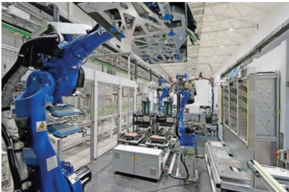
Nova proizvodna linija za lahke aluminijaste dele za pogonski sklop popolnoma električnih avtomobilov BMW / Foto: LTH Castings
