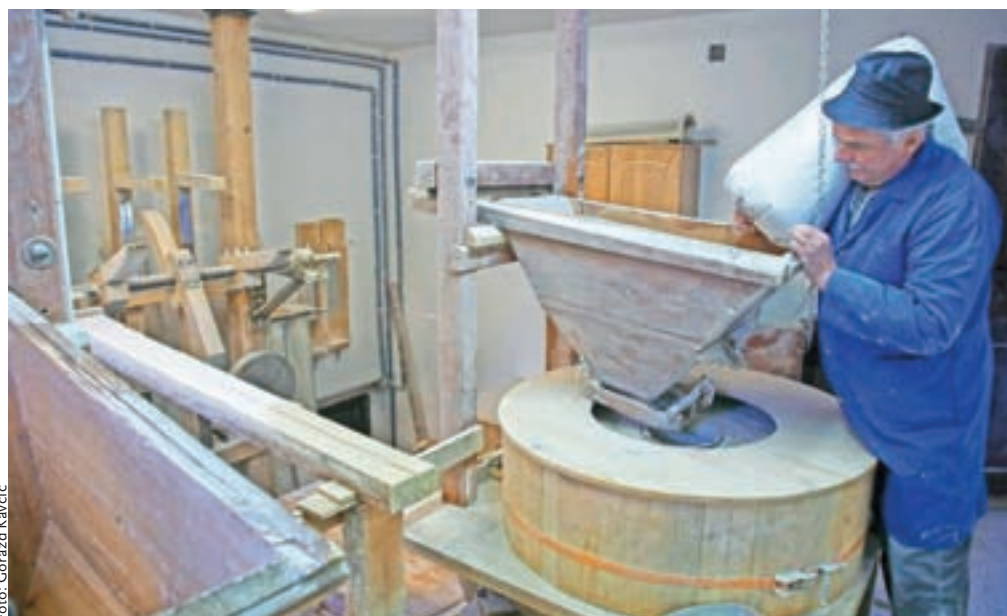
Mlin je ostal praktično enak kot nekoč, le mlinsko kolo zdaj poganja elektrika.
