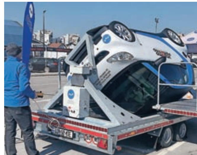
Simulator Vrtavček je naprava za prikaz pravilne uporabe varnostnega pasu in ga lahko preizkusite na preventivnih akcijah.
