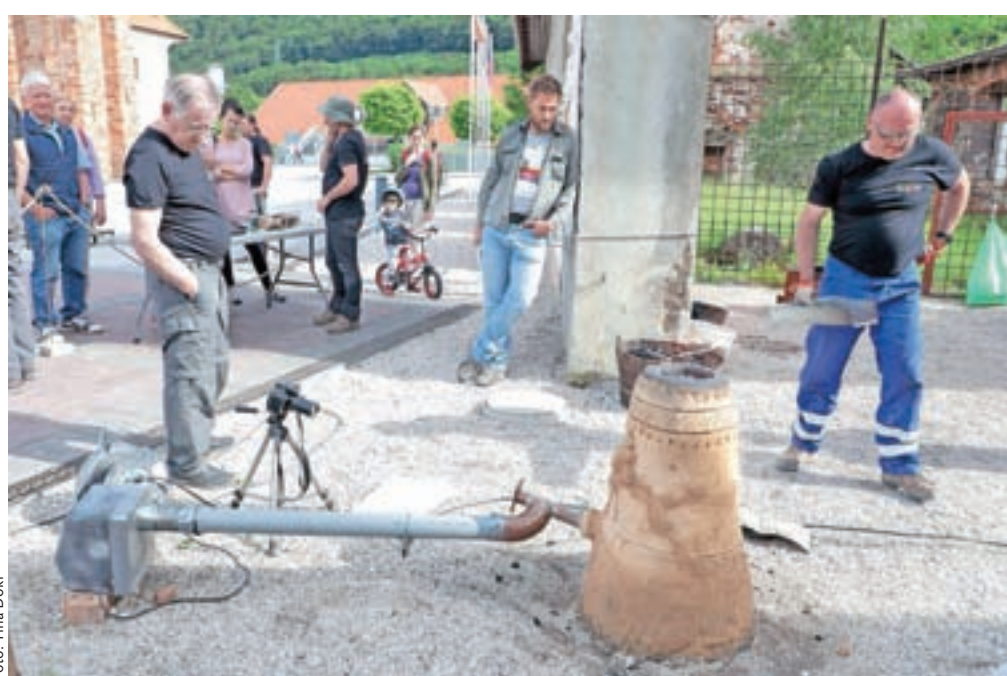
V vetrni peči so talivci iz Železnikov talili železovo rudo po postopkih, starih 2500 let.
