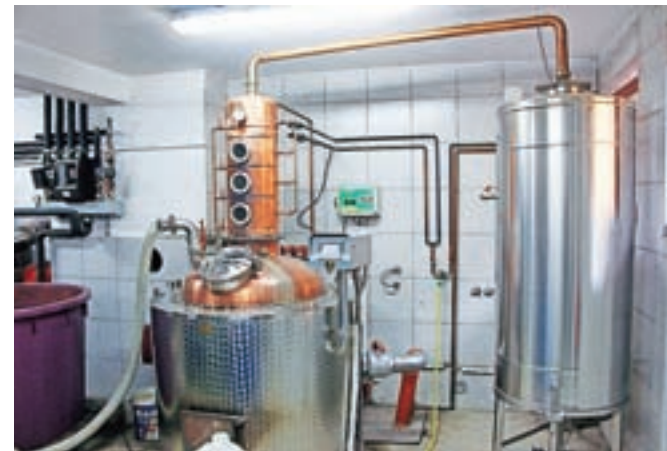
Sodobna, računalniško vodena žganjekuha
