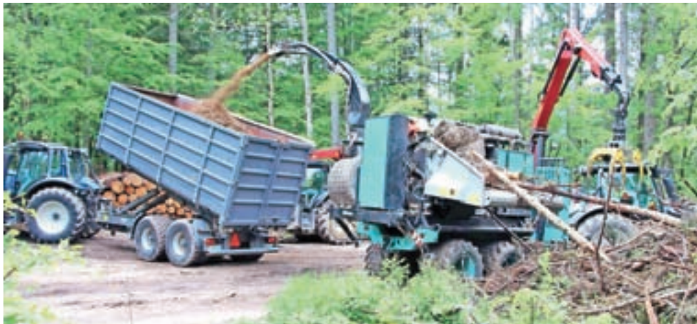
Prikaz izdelovanja sekancev iz gozdnih lesnih odpadkov
