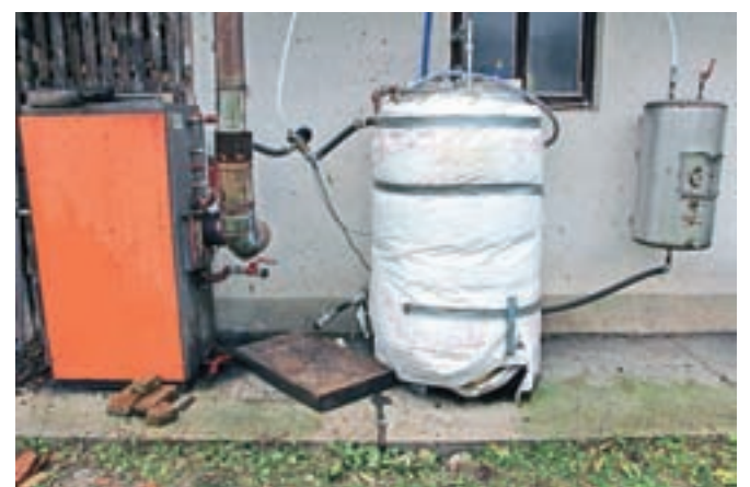
Anže je s prijateljevo pomočjo izdelal pasterizator na drva.
