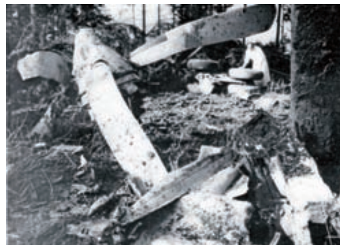
Skrivljena elisa enega od motorjev strmoglavljenega letala / Foto: Franc Perdan (Fototeka Gorenjskega muzeja)
