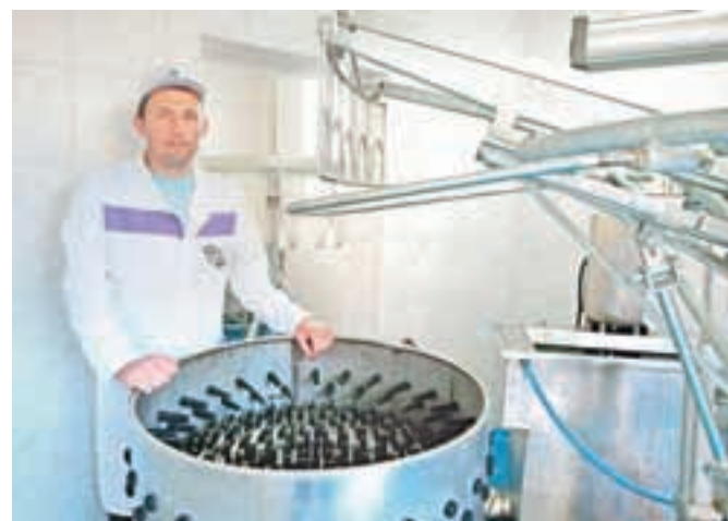
Tomaž Ažman ob skubilniku, končni postaji avtomatizirane štirifazne krožne klavnice za zakol piščancev. / Foto: Gorazd Kavčič
