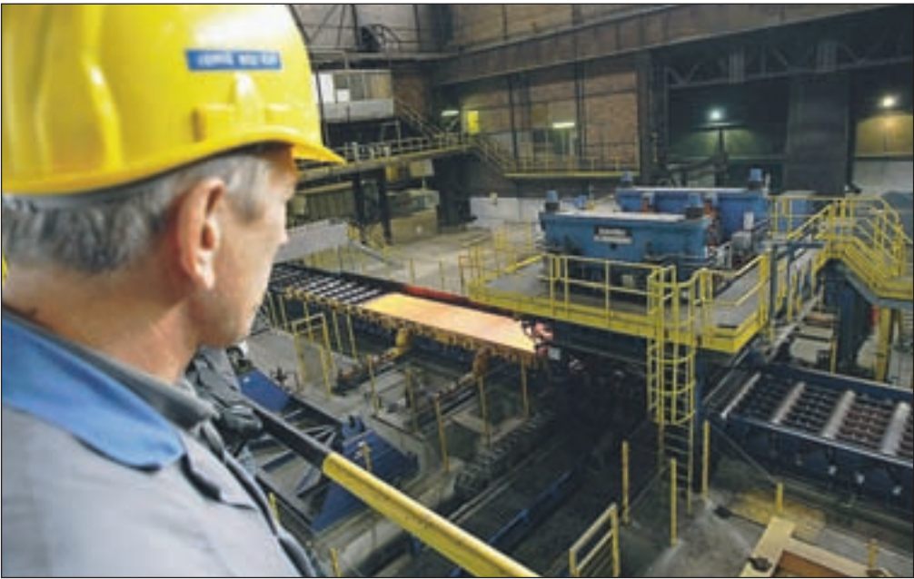
Nova linija za izdelovanje debele pločevine je povsem avtomatizirana, ob njej delajo le še trije zaposleni. / Foto: Gorazd Kavčič
