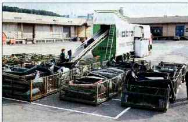
Programirana razgradnja pomeni odstranjevanje in sortiranje posameznih sestavnih delov ter ločitev na tiste, ki jih je ali ni mogoče reciklirati.
