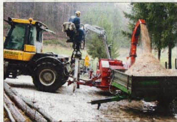
Rok Suhadolnik iz Logarske doline je v Turkovem gozdu prikazal delovanje traktorskega sekalnika, ki lahko naredi na uro do trideset prostorninskih metrov sekancev in razseka v sekance do 40 centimetrov debelo drevje. Izdelava sekancev stane od 700 do 800 tolarjev za meter.
