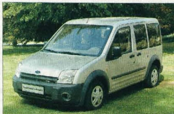
Pravzaprav ime connect ponazarja dva avtomobila v enem, pod oznako transit connect je nastala različica z zaprtim tovornim prostorom, tourneo connect pa je potniška izvedba z zaštekljenim zadnjim delom kabine in sedeži. Na pogled je vozilo s karoserijskimi potezami v Fordovem slogu new edge sodobne in prijetne zunanjosti, sicer pa temelji na mehanički nove fieste z ustreznimi prilagoditvami podvozja. Na voljo sta dve različni dolžini (4,3 in 4,5 me-
