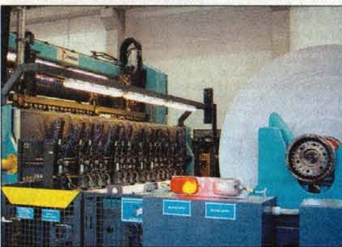
Nov vzdolžni rezalni stroj v papirnici Goričane.
