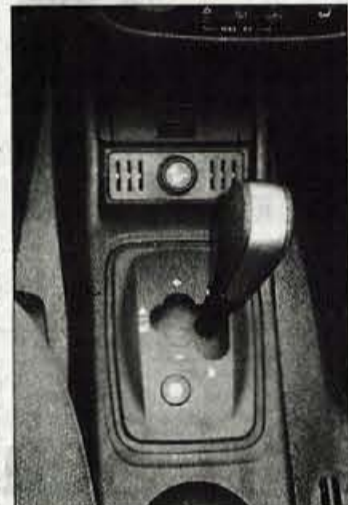
Easytronic: ročica kot pri ročnem menjalniku, vendar z drugačnimi pomiki in brez stopalke sklopke.
