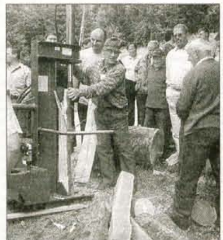
Hidravlični cepilec drv je varnejši od svedrastega.
