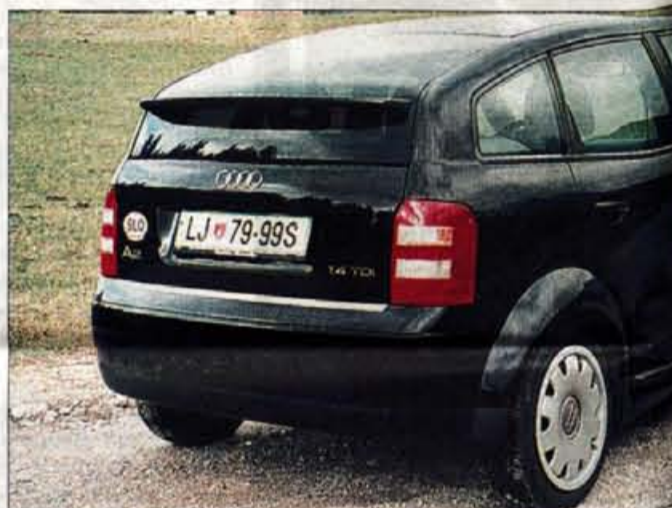
Posebnost na zadnjem delu: zalomljeno zadnje steklo z nalepljenim stabilizatorjem zraka.
