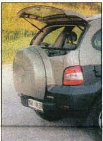
Deljeno odpiranje vrat: najprej stekleni del, nato še pločevina, ki se odpira na stran.
