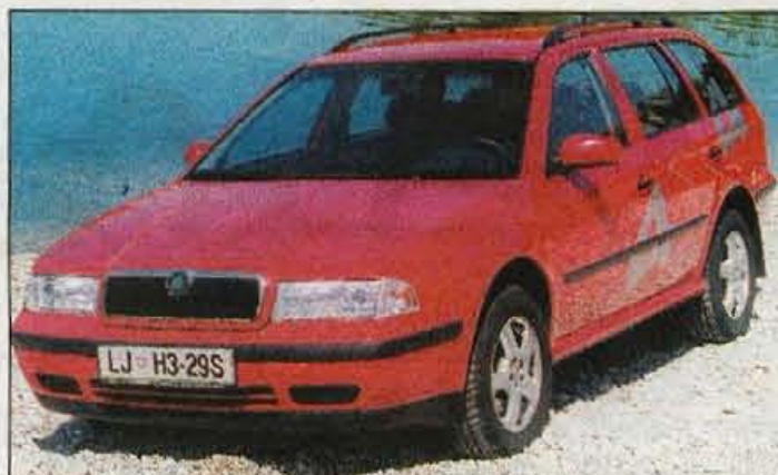
Škoda octavia s štirikolesnim pogonom se na prvi pogled ne razlikuje od običajnih različic je pa dobra dva centimetra višja.
