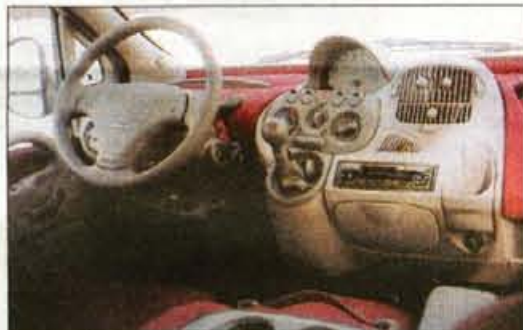
Notranost sledi nenavadni zunanosti: tridimenzionalna armaturna plošča z velikim merilnikom hitrosti, manjka merilnik vrtljajev.
