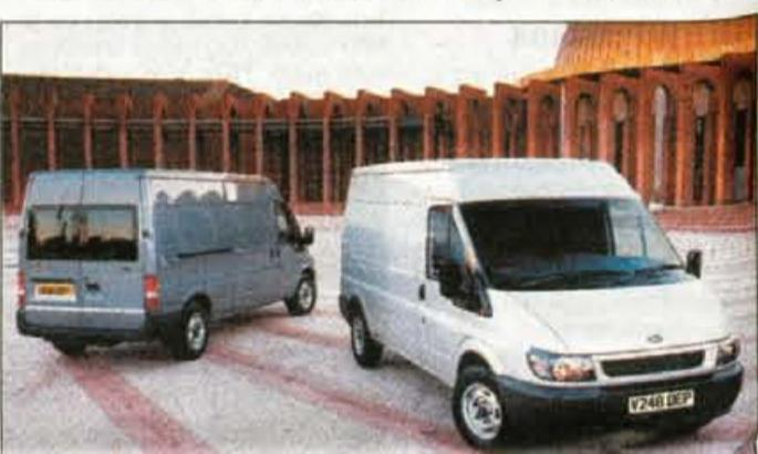
Pogon sprednje osi naj bi služil zunanjost ampak tudi na udobje predvsem vozilom z manjšo nosilnostjo do 2,8 tone, za vozila nad to nosilnostjo pa je primernejši zadnji pogon. Modularnosti platforme so konstruktorji prilagodili tudi motorni prostori, zato je mogoče vgrajevati prečno ali vzdolžno postavljene pogonske stroje.
