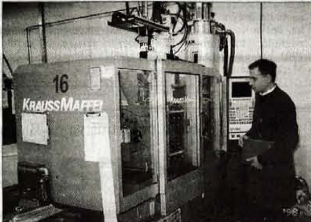
V livarni strežejo livarskim strojem roboti. Livar lahko tako nadzoruje dva stroja hkrati.
