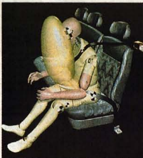
Za potnike na zadnji klopi so razvili nove varnostne vreče, ki so nameščene v horizontalnem delu varnostnega pasu, plinski generator je nameščen v dnu potniške kabine.
