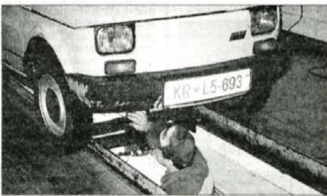
Najbolj pogoste pomanjkljivosti: zavore, podvozje in svetlobna oprema.
