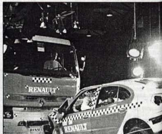
Simulacija trčenja 1268 kilogramov težkega renaulta megana v 16 tonski tovornjak reault premium.
