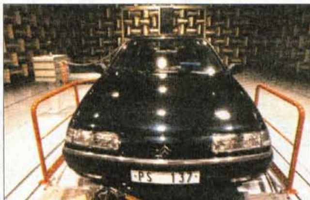
Citroenova xantia na preizkusu v akustični komori, kjer opravljajo raziskave hrupa in potniški kabini v kombinaciji z vibracijami dna karoserije.
