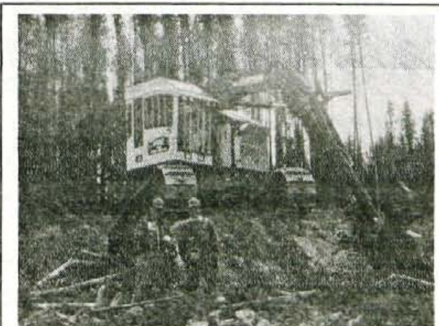
Sekač-zlagalec pri tleh odreže drevesa, jih zgrabi in odnese na kup, odkoder jih traktor odvleče na skladišče, kjer jih oklestijo in pripravijo za odvoz. To je v notranjosti Kanade na položnih legah prevladujoč način sečne in spravila lesa.
