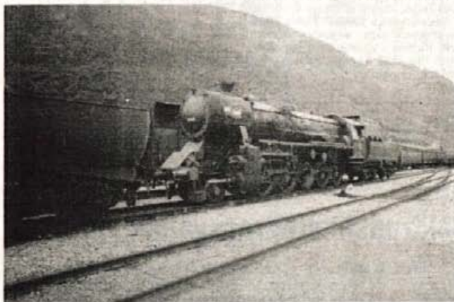
Lokomotiva nemške proizvodnje izpred prve svetovne vojne, z desetimi pogonskimi kolesi, teška 96 ton, je med vojno služila bojnim transportom po vsej Evropi.
