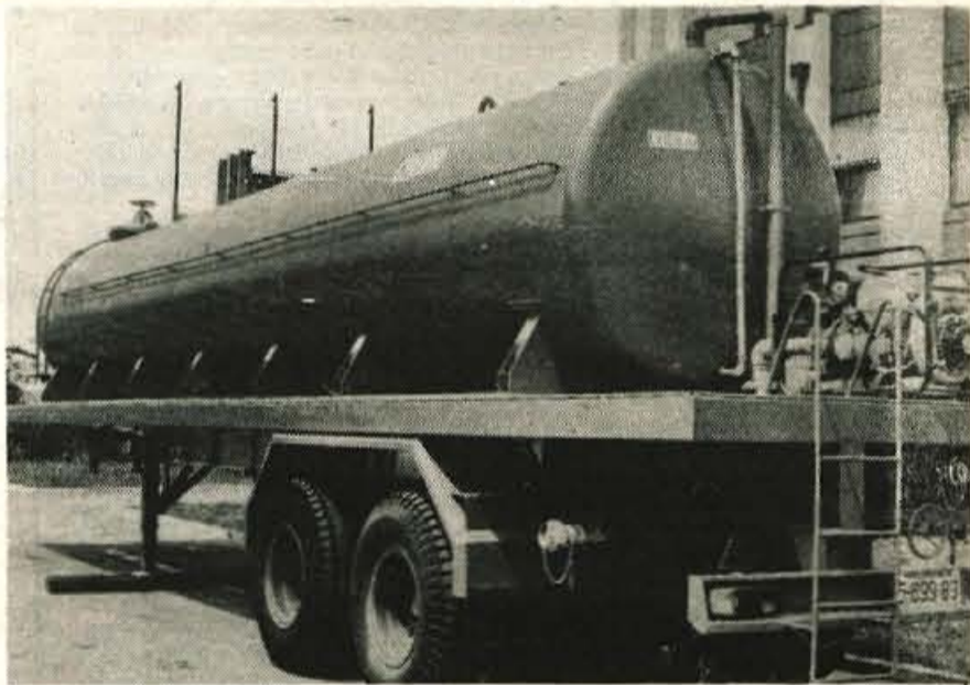
CISTERNA ZA 20.000 LITROV VODE — Alpetour, delovna organizacija Creina, kmetijska mehanizacija, je za potrebe puljskega območja, kjer večkrat zmanjka pitne vode, izdelala veliko cisterno z zmogljivostjo 20.000 litrov. Cisterna, za katero so podvozje izdelali v ITAS-u, ima v notranjosti posebno zaščito s kvalitetnimi premazi in je prva tovrstna cisterna kranjske kmetijske mehanizacije. Stane 10 milijonov dinarjev. — Foto: F. Perdan
