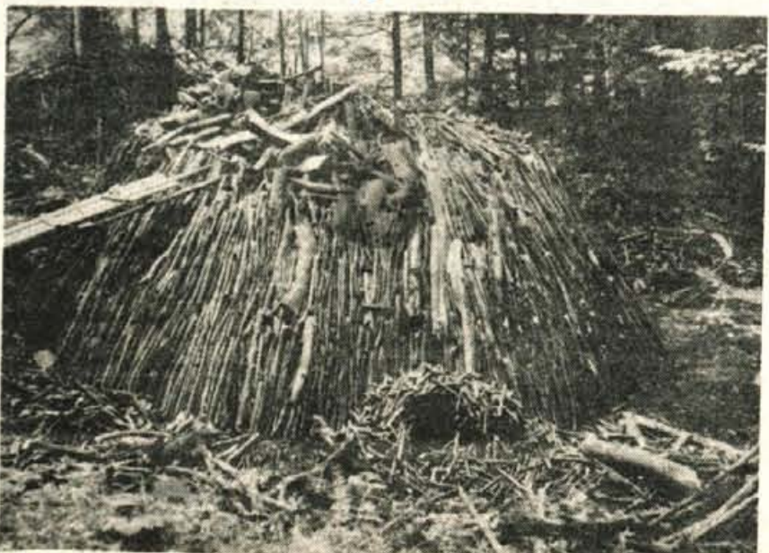
Pripravljena drva za kuhanje oglarja postavi oglar na kopsišču pokončno okoli strežnice, ki ima običajno obliko trikotra. Drva zloži običajno v dva sklada, na zgornjega pa zloži še kratka in drobna drva po dolžini.
