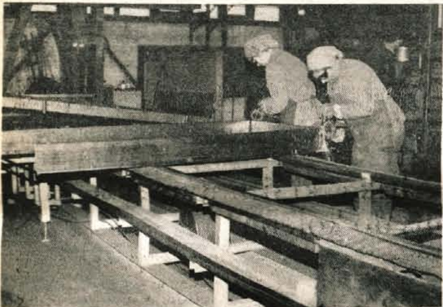
Delavci brusita robove kovinskega podboja
