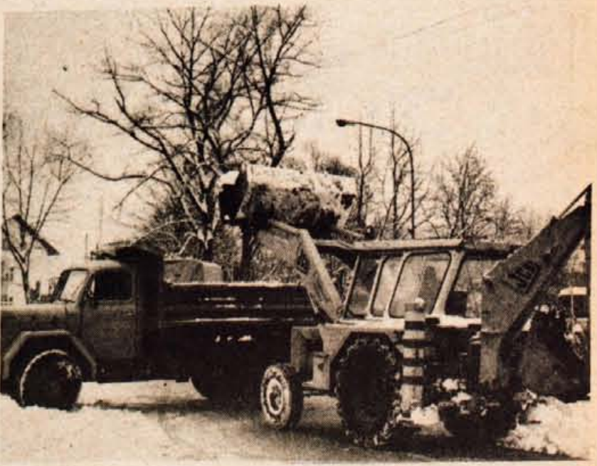
Kranjsko komunalno podjetje se je lotilo strojnega čiščenja pločnikov, ki se je izkazalo učinkovitejše od ročnega. Tovornjaki odvažajo sneg v strugo Kobre. Žal neprimerno postavljeni drogovi javne razsvetljave na robovih pločnikov ovirajo nemoteno delo strojev. (jk) – Foto: F. Perdan
