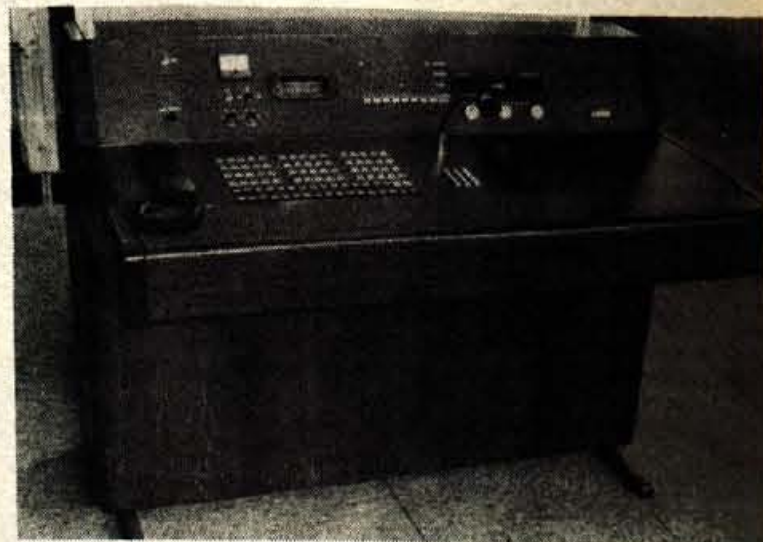
KOMUTACIJSKA NAPRAVA ZA OPRMO CENTROV OJOA je namenjena za komutacijo vseh vrst telekomunikacijskih zvez. Na njej lahko dela do 5 delavcev in je primerna predvsem za službo OJOA v centrih za zveze DPS in centrih vseh ostalih funkcionalnih zvez.
