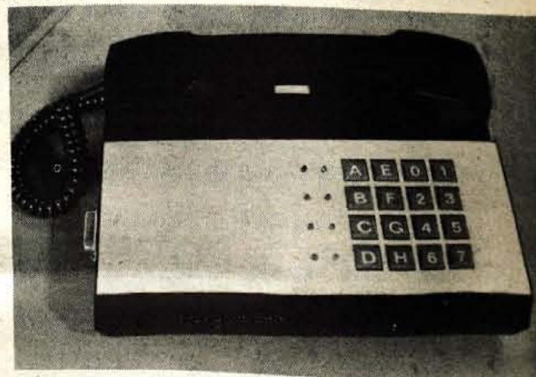
DIGICOM je telefonska naprava, ki v sistemu telekomunikacij predstavlja zelo sodobno sredstvo. Sistem omogoča gradnjo lokalnih telefonskih omrežij brez telefonske centrale do 240 števil.
