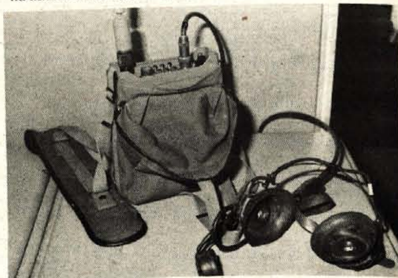
SPREJEMNO ODDAJNA radijska naprava za vzpostavljanje lokalnih radijskih omrežij, katere moč je 600 kanalov.
