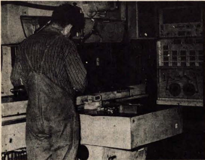
Med najsodobnejšo strojno opremo ima IKOS tudi 2 numerično krmiljena rezkalna stroja, ki po pripravljenem programu lahko s šestimi upetimi orodji opravita tudi po deset in več zahtevnih operacij brez posredovanja delavca. Uporablja jih za izdelovanje najzahtevnejših strojnih delov, ki terjajo največjo možno natančnost. Foto: S. Hain
