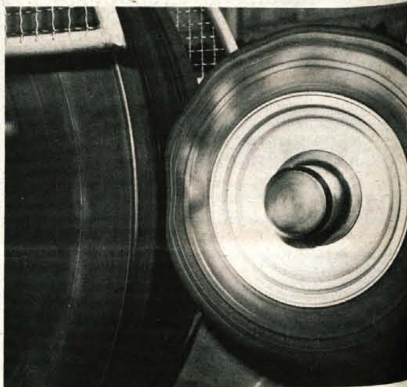
Hitrostno preizkušanje radialnih avtoplaščev
