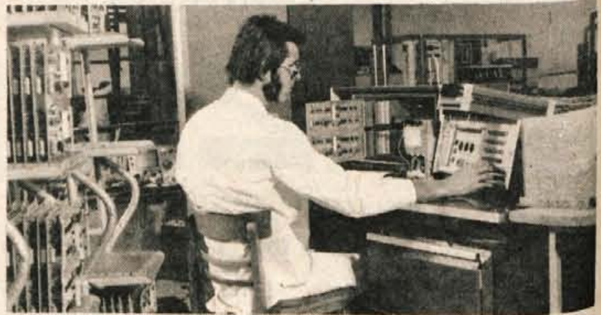
Telekomunikacije na Laborah. Na fotografiji kontrola elektronskih enot za METACONTO 10-C
