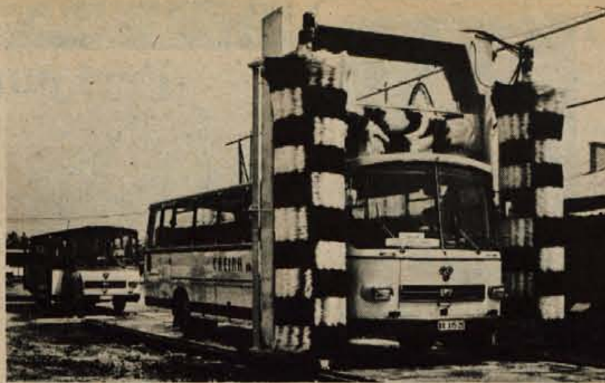
Creina iz Kranja je uredila pred kratkim v obratu na Primskovem avtomatsko pralnico za autobuse, tovorna vozila in osebne automobile, za kar je odštela 40.000 dinarjev. V novi avtomatski pralnici operejo na primer avtomobil v petih minutah, osebno vozilo pa v precej krajšem času. Vozilo po želji naročnika operejo s čisto vodo, šamponom ali voskom, tako da dobi ploščina tudi sijaj. Pralnice ne bodo uporabljala le vozila domačega podjetja, temveč tudi drugi lastniki motornih vozil. (jk) — Foto: F. Perdan
