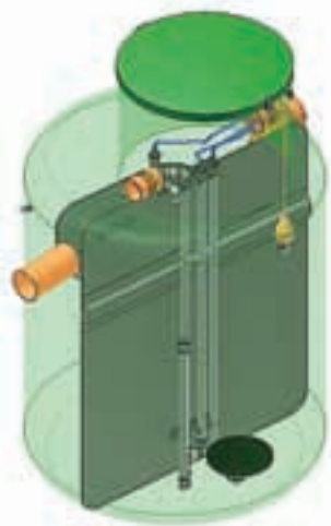
3D risba pokončne biološke čistilne naprave
