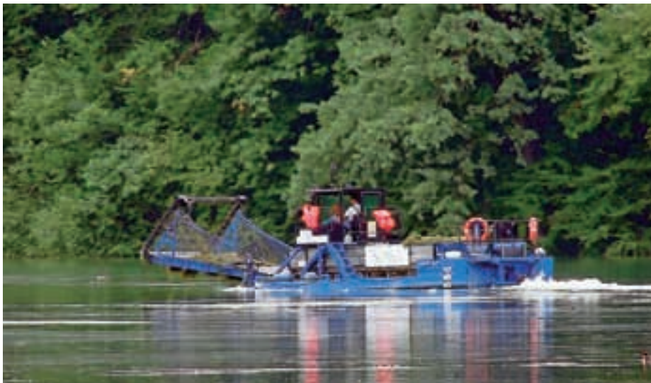
Podvodno rastlinje so poleti redno odstranjevali s posebnim plovilom Sava.
