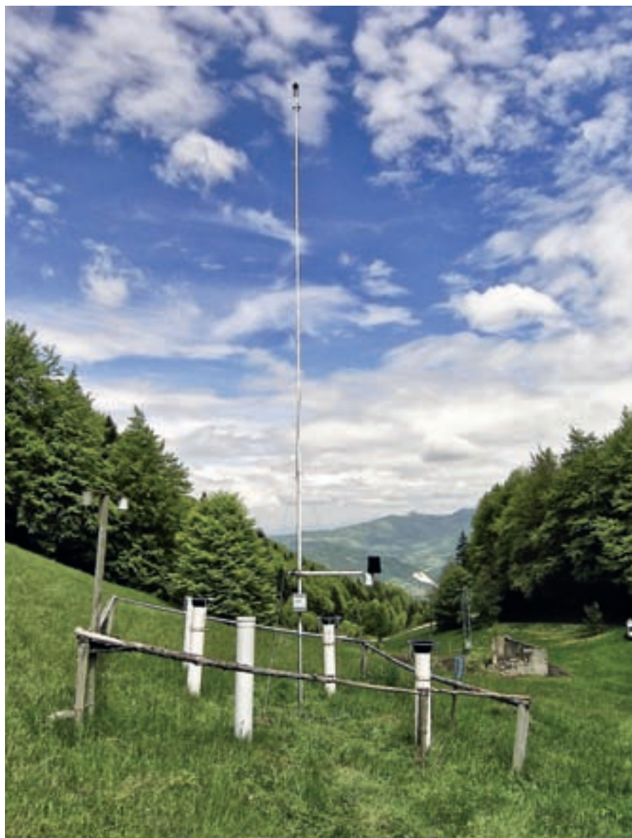
Samodejna meteorološka postaja Gozdarskega inštituta Slovenije, ki meri hitrost in smer vetra, sevanje sonca, padavine, temperaturo, relativno zračno vlago in zračni tlak. / Foto: Iztok Sinjur
