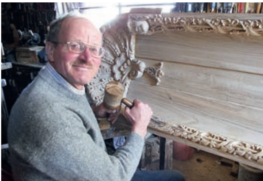
Hansi Elbe z dletom in kladvom izdeluje vhodna grajska vrata.
