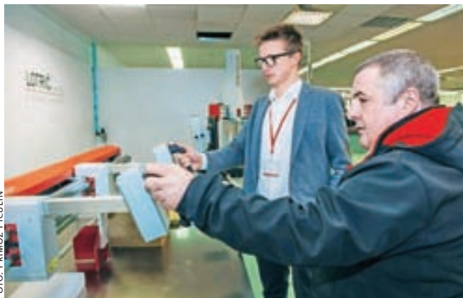
Podjetje Lotrič Meroslovje je predstavilo tudi svoj nov produkt Trames Unique, ki so ga izdelali za Knauf Insulation. Stroj meri dimenzijo in maso produkta, kar omogoča izračun gostote, ki je pri izolativnih materialih ključnega pomena.
