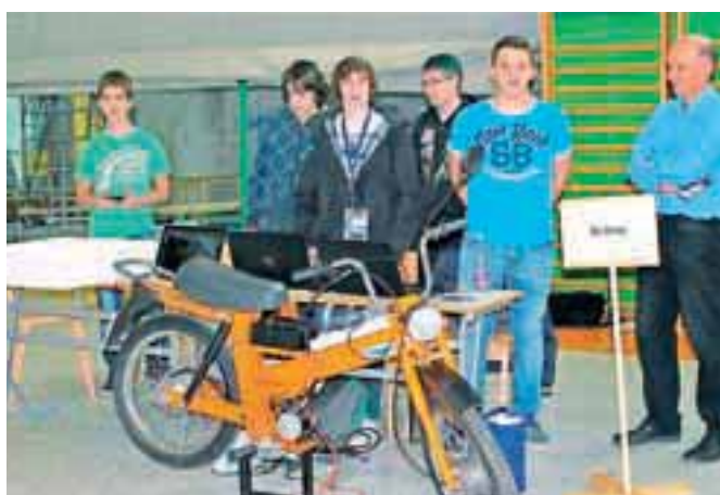
Trije dijaki Šolskega centra Kranj so bencinski motor predelali v električnega.
